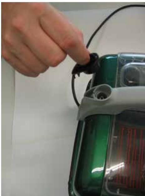
Sobald der Verschluss des Griffs entfernt wurde, muss die Flasche (nur mit Wasser gefüllt) eingesetzt werden (siehe Abb. 9).
