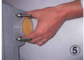
Die Pflege und die Wartung dieses Filters sind besonders wichtig, um am Saugausgang eine saubere Luft zu erhalten. Wir ersuchen Sie daher, den Zustand des Filters zumindest ein Mal pro Monat zu überprüfen, wenn das Gerät täglich verwendet wird. Um den Filter zu überprüfen, nehmen Sie die oben bildlich dargestellten Abläufe in umgekehrter Reihenfolge vor.
