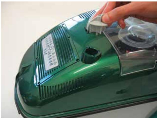
Auf diese Weise haben Sie Zugriff auf das Ventil, das das Reinigungsmittel ins Innere des Geräts und anschließend zu den Zubehörteilen leitet.
